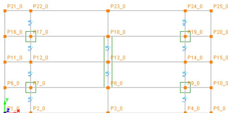
A solo scopo dimostrativo si è schematizzata una piccola platea su cui ricadono 4 pilastri, una parete (baricentro nel nodo 13) che si estende in altezza per più piani e due pareti di cantinato che passano rispettivamente per i pilastri 7-17 e 9-19.
